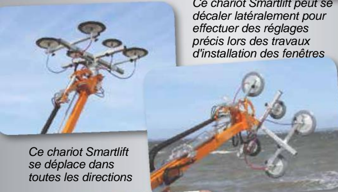
La tête rotative hydraulique multifonctionnelle
